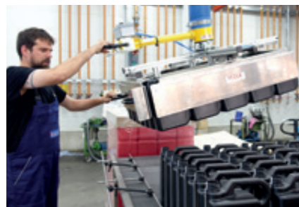
Kanistergreifer Pneumatisch ausgestatteter Spanngreifer für das gleichzeitige Umsetzen von bis zu 20 Kanistern auf ein Mal.
