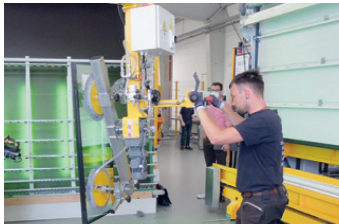
VacuBoy VB-VERT-180E-250KG mit elektrischem Drehantrieb in der Produktion von mehrfach verglasten Fensterscheiben
