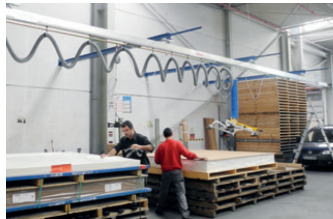
HBS-ESK-125KG-12000 Einschielenkran für das Umlagern von Plattenmaterial
