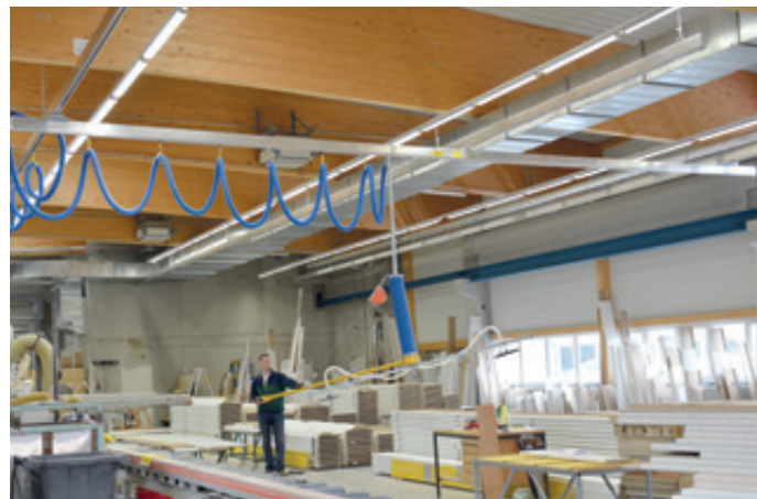
HBS-ETK-80KG-16000x12000 Einträgerkrananlage mit 3 Kranbahnen für die Überspannung einer Brückenlänge von bis zu 12.000 mm
