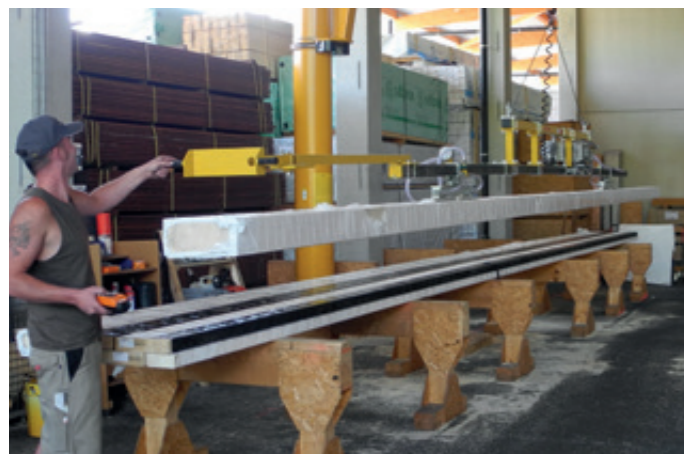
VacuWood VWLB-250 für in Folie verpackte Leimbinder bis 14.000 mm Länge
