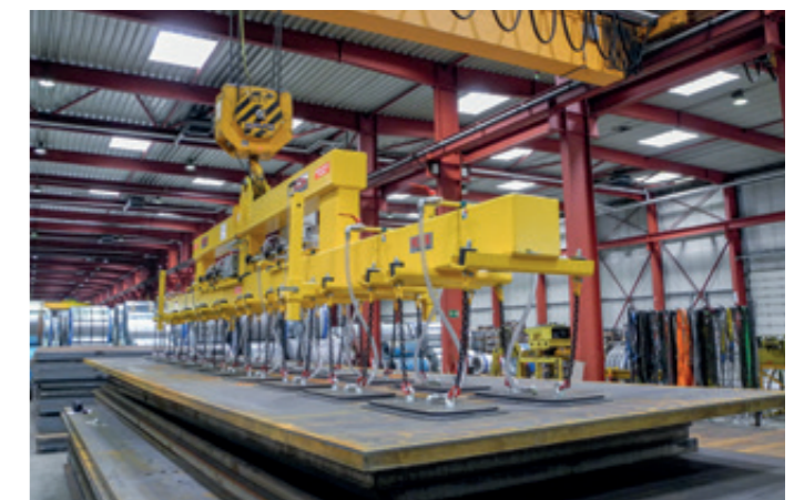
VacuGiant VG-25000KG mit doppelreihiger Saugplattenanordnung für den Transport von Stahlblechen bis Abmessungen von 14.000 x 3.000 mm
