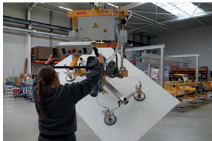
VacuBoy VB-90E-180E-250KG elektrischer Schwenk- und Drehantrieb für die Handhabung von Plattenmaterial
