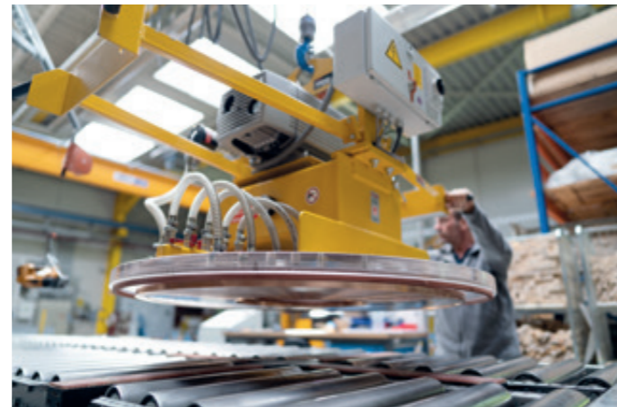
VacuCoil VC-500KG mit Plexiglassaugplatte für das einfache zentrische Aufsetzen auf die Spaltbandringe
