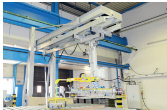
HBS-ZSK-500KG-6000 Zweischienenkran mit Liftfix für die Blechbeschickung einer Laserschneidanlage
