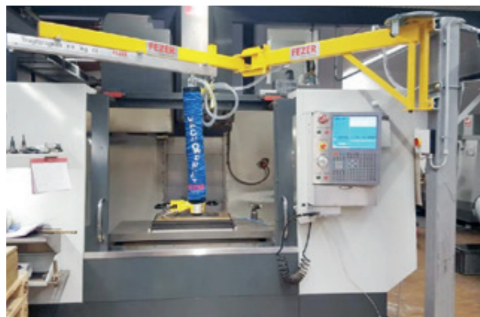
KSK-2500-2500-80KG für die Beschickung einer Bearbeitungsmaschine
