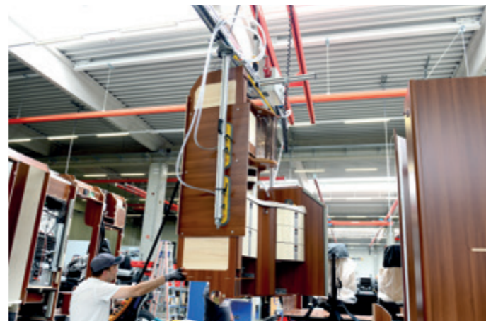
VacuBoyVario VBV-125KG Handhabung von komplett vorgefertigten Möbelteilen in der Endmontage
