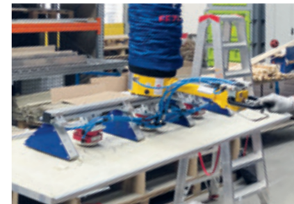
Kombigreifer Nadel- und Magnetgreifer für Dämmmaterial und Lochbleche. Die Ansteuerung erfolgt über zwei Pneumatikventile.
