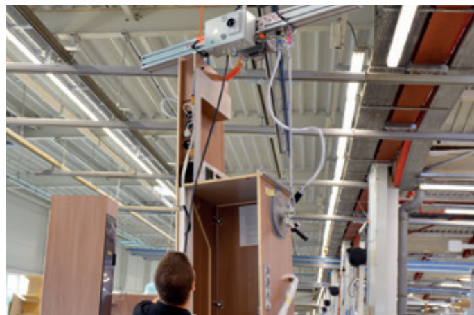
VacuBoyVario VBV-125KG Umsetzen von Möbelementen in der Wohnmobilindustrie
