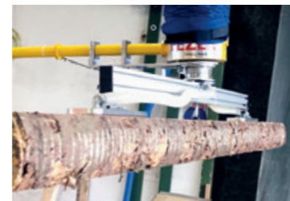
Sauggreifer für Langgüter Mit einer verstärkten Längsträgerausführung für die Handhabung von Langgütern bis 6.000 mm.
