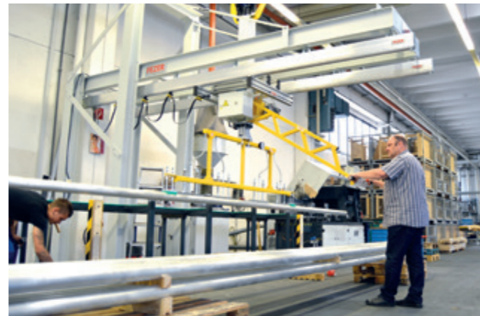
Lifffix LF-ET-125KG Starres Hubsystem mit Einfachteleskop für die Handhabung von Rohren
