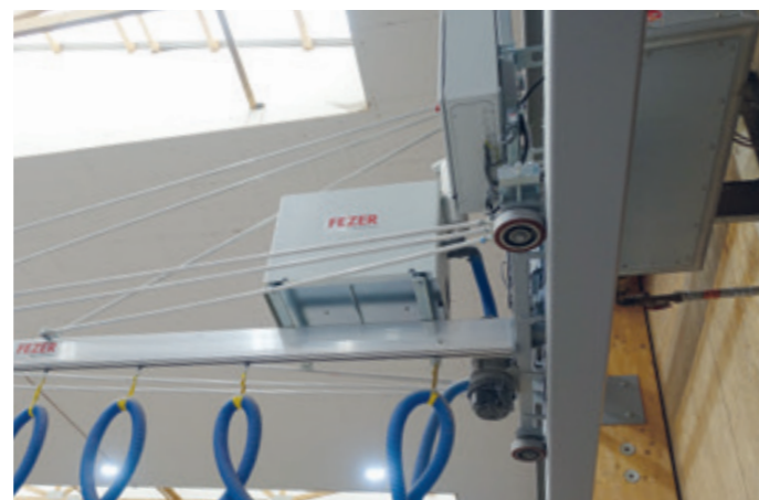
Wandlaufkran WLK-120KG-44.000x7.000 mit elektrisch verfahrbarem Ausleger (7.000 mm) mit integrierter Kollisionsverhinderung.
