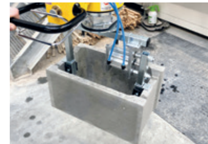
Pneumatikgreifer Mit Spannvorrichtung zum Umsetzen von Hohlsteinen.
