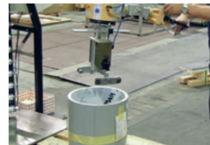
Pneumatikgreifer Mit Innenspannbacken für das Umsetzen von Spaltbändern.
