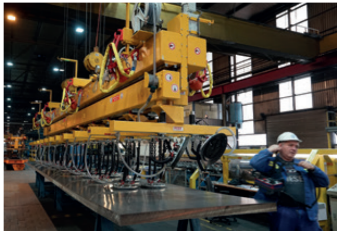
VacuGiant VG-12000KG-TEL elektrisch teleskopierbare Vakuumtraverse für die Beschickung einer Reckbank
