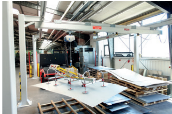
HBS-ETK-500KG-12000x6000 Einträgerkrananlage mit verstärkter Brücke für höhere Belastung
