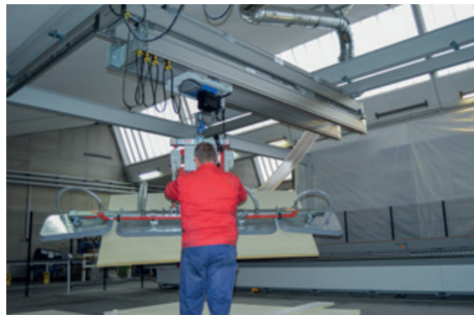
HBS-DB-500KG-8000x4000-TEL2000 Beschickung einer CNC-Bearbeitungsstation über teleskopierbare Doppelbrücke
