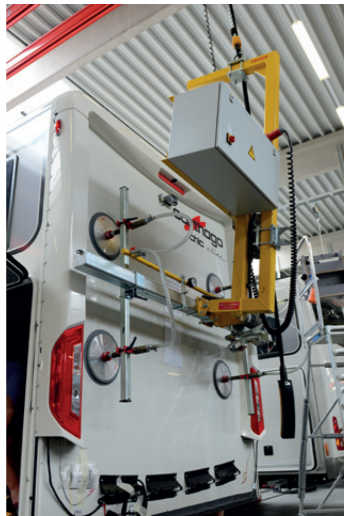
VacuBoy VB-VERT-250KG bei der Endmontage von Rückwänden in der Wohnmobilbranche
