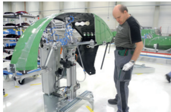
VacuStand VS-I-AL-AS/SO mit ACCU-Modul und elektrischer Höhen- und Schwenkverstellung
