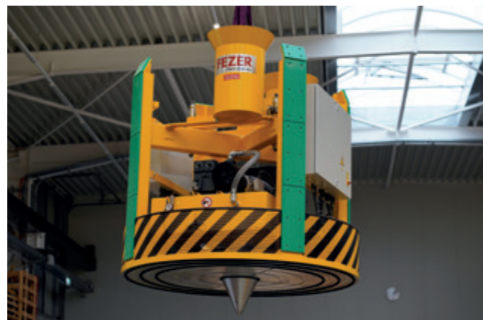
VacuCoilPaper VCP-4000KG im Automatiklager mit 3 Saugkammern, automatischer Kammererkennung und Zentrierdorn
