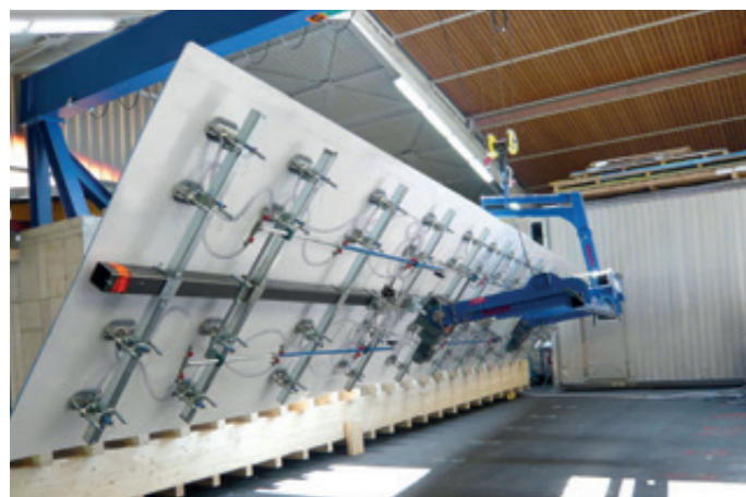
VacuGiant VG-180E-1500KG mit Ausgleichsaufhängung und Gabelstaplerschuhen zum Wenden von Kunststoffplatten mit Maßen von bis zu 16.000 x 3.500 x 10 mm
