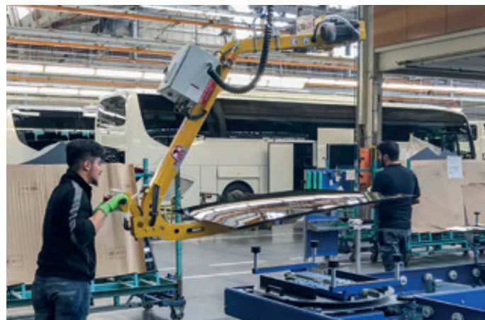
VacuBoy VB-180E-50KG in niedriger Bauweise über Zahnstange für Glasscheiben
