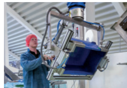
Kistengreifer Zum pneumatischen Klemmen und Schwenken von Kunststoffkisten.
