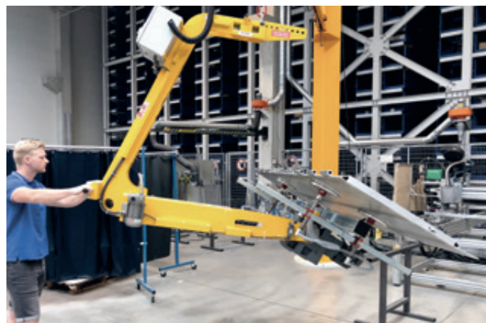
VacuBoy VB-180E-250KG Wenden von aufgekanteten Stahlplatten
