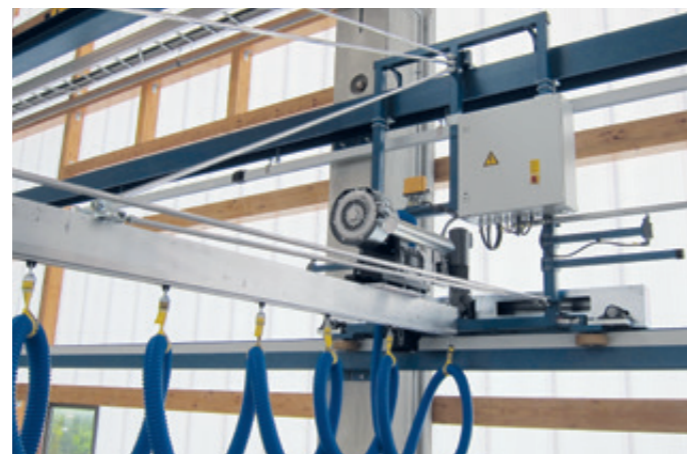
Wandlaufkran WLK-100KG-68.000x7.000 mit elektrisch verfahrbarem Ausleger (7.000 mm)
