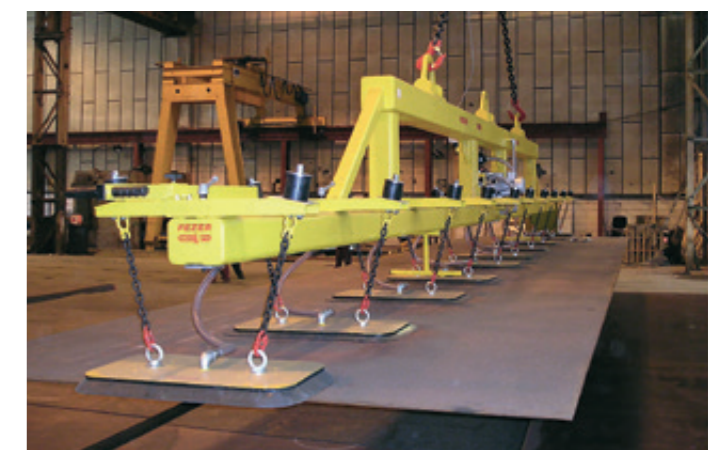
VacuGiant VG-12000KG mit einreihiger Saugplattenanordnung für Stahlbleche bis 20.000 x 3.500 x 50 mm
