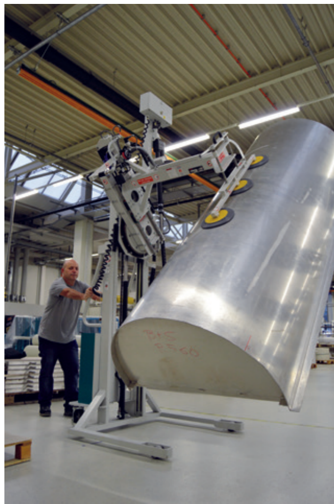
MobiliftMaxi ML-3000-250KG mit elektrischem Dreh- und Verstellantrieb für die Ein- und Auslagerung großer und schweren Werkzeugformen
