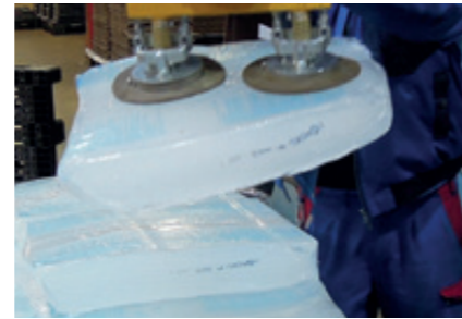
Ballen-Sauggreifer Mit zwei Flach-Sauggreifer mit spezieller, verstärkter Gummi-Ausführung.
