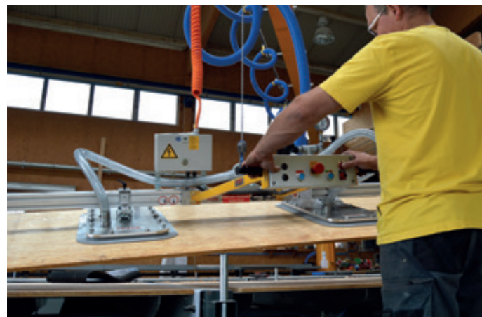
VacuPoro VP-500KG mit integrierter Kransteuerung für das Umsetzen von MDF- und OSB-Platten
