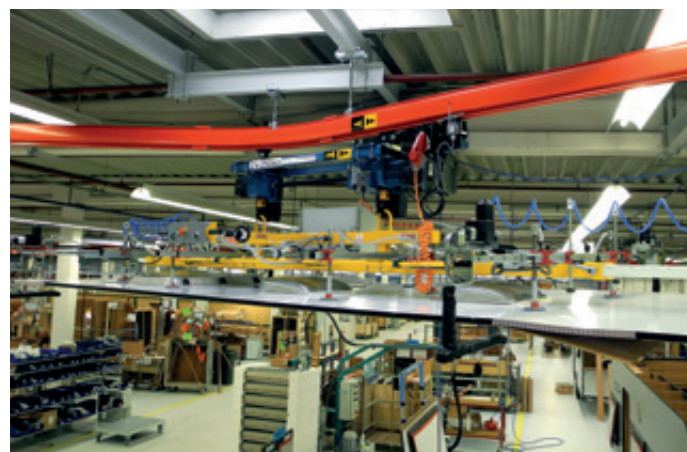
VacuBoySystem VBS-500kg in Flachbauweise und mit einschwenkbaren Untergreifer als Sicherheitsvorkehrung für den Transport über Personen
