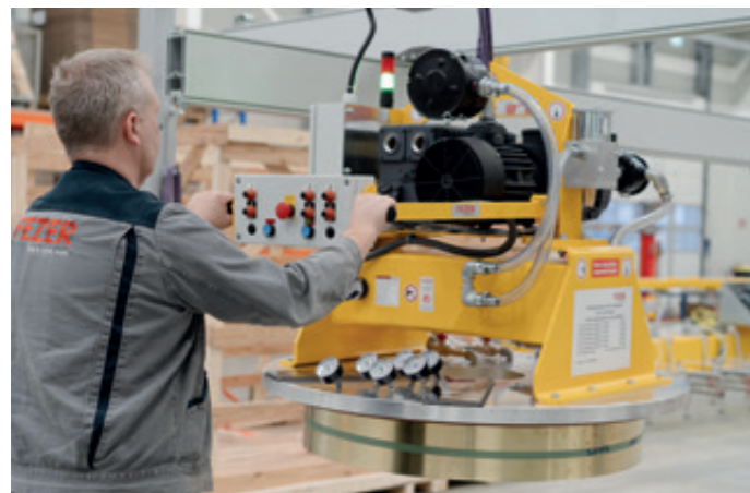
VacuCoil VC-500KG mit insgesamt 5 Saugkammern für die Aufnahme von Spaltbändern mit Durchmesser von 400-1.400 mm
