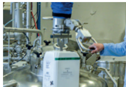
Kanistergreifer Einfacher Hakenreifer zum Untergreifen der Kanisterlasche mit Lastausgleichsventil für die Vakuumsteuerung.
