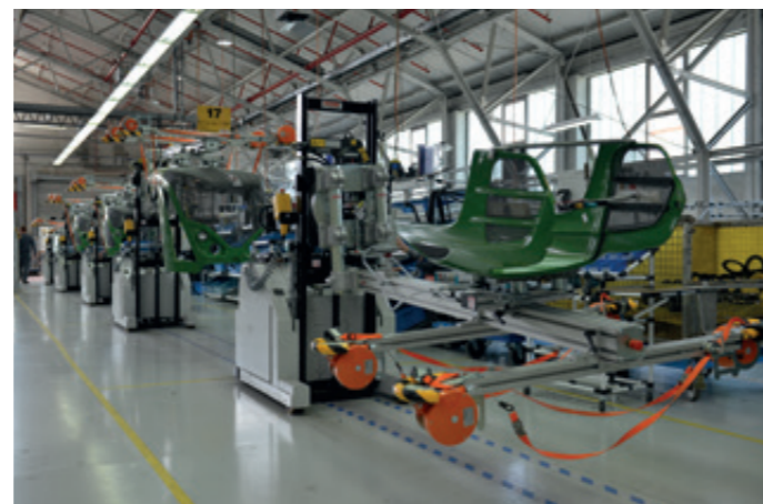
MobiliftMaxi ML-2000-500KG in der Vormontage von Motorhauben im gewendeten Zustand
