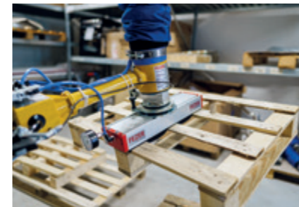
Flächengreifer Mit Flächensauggreifer und integriertem Ejektor.
