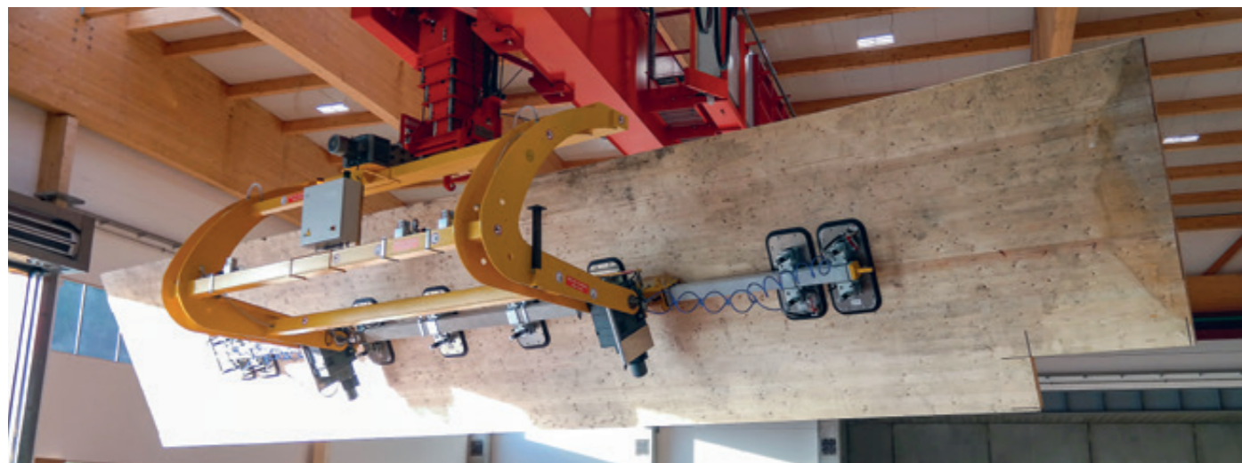
VacuGiant VG-180E-5000KG Wenden von Massivholzplatten bis 12.000 x 3.500 x 100 mm
