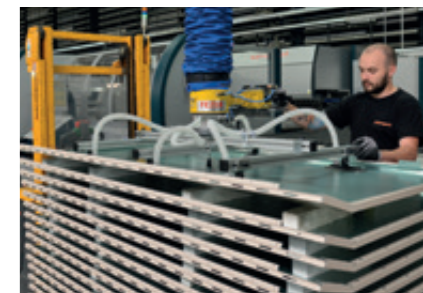
Sechsfach-Sauggreifer Für die Handhabung von großflächigem und dünnwandigem Plattenmaterial.
