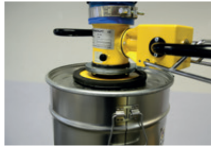
Einzel-Sauggreifer In runder, flacher oder Faltenbalgausführung für Fässer, Behälter und kleinere Kartonagen.
