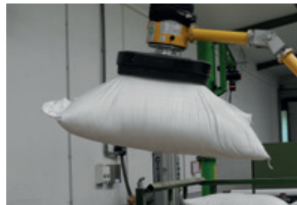
Sack-Sauggreifer In Kunststoff-Ausführung mit zwei Größen für kleine und große Papier- und Kunststoffsäcke.
