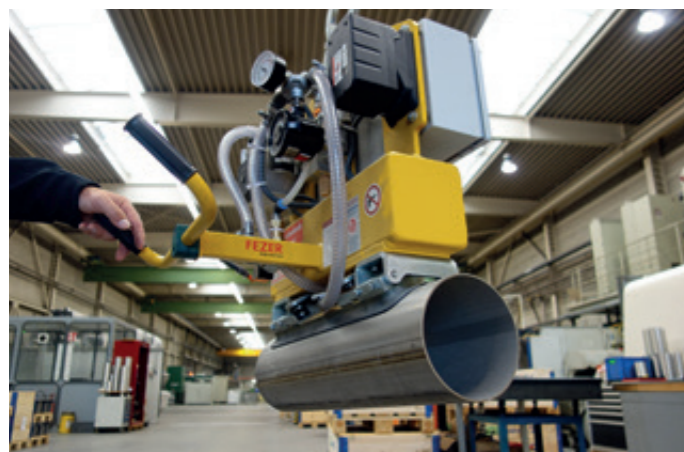
VacuBoyMini VBM-ACCU-50KG mit gelenkigen Spezialgreifern für den Transport von Rohren mit unterschiedlichen Durchmessern
