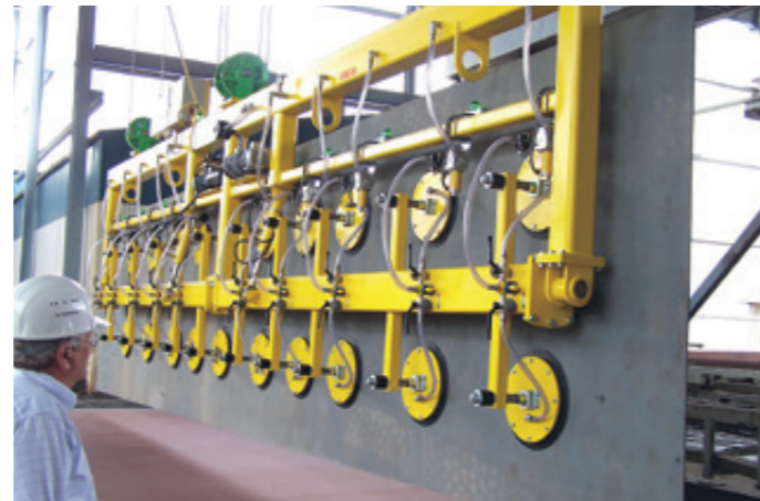
VacuGiant VG-90E-7500KG für großflächige Stahlplatten bis 4.000x2.000 mm
