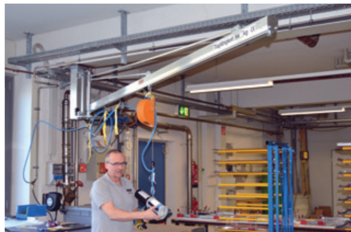
DSK-5000-50KG mit Schwenkbegrenzer und Balancer-Zug
