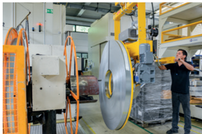
VacuCoil VC-90E-1000KG für Aluminiumspaltbänder bis 1.800 mm Durchmesser
