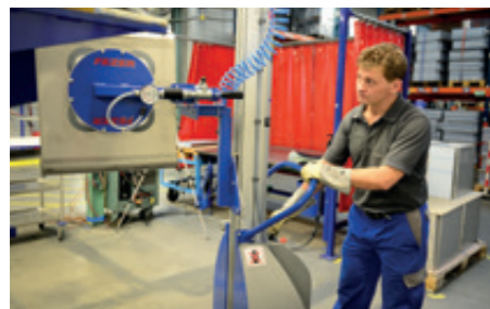
MobiliftMini ML-200-1500-100KG mit integrierter Vakuumtechnik für die Handhabung von Blechbehältern
