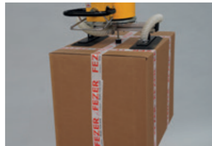
Doppel-Sauggreifer Mit runden und rechteckigen Sauggreifern, ideal für Kartonagen.
