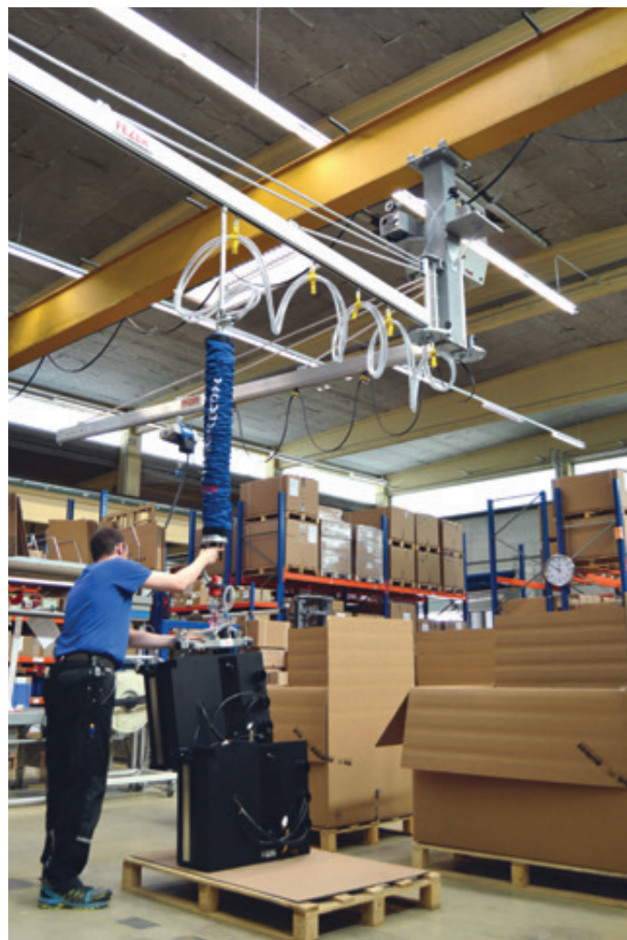
DSK-4000-50KG zum Unterfahren einer bestehenden Kranbahn
