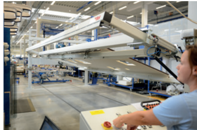
Wendestation SWS-270E-HV-200KG mit Höhenverstellung und pneumatisch verstellbaren Saugelementen für Wohnmobildachelemente
