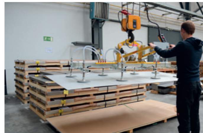
VacuBoy VB-1000KG Kommissionieren von Stahlblechen
