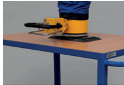
Einzel-Sauggreifer In flacher, rechteckiger Ausführung für Werkstücke mit schmalen Ansaugflächen.
