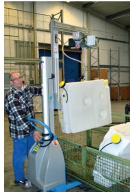
MobiliftMini ML-200KG-2000 mit integrierten Vakuumheber für die Entnahme von Behältern
