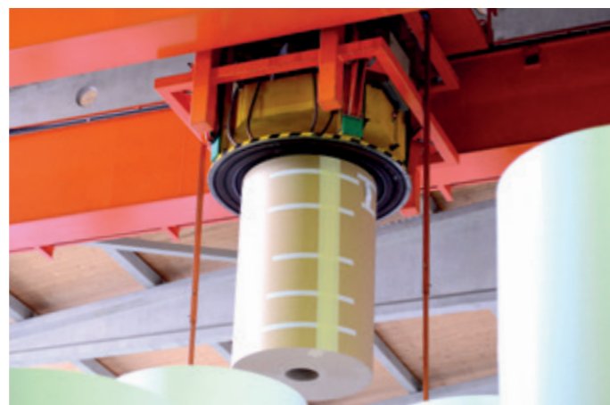
VacuCoilPaper VCP-6000KG im Automatiklager für Papierrollen bis 2.500 mm Durchmesser und Breiten bis 2.750 mm
