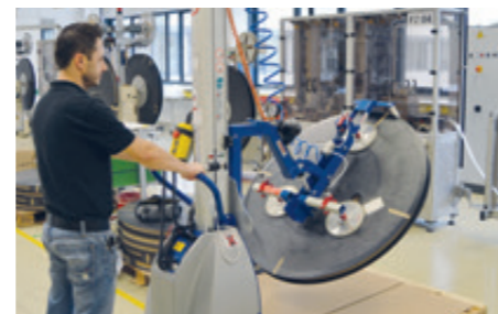
MobiliftMini ML-100KG-2000 mit integrierter Vakuumtechnik und elektrischer Schwenkeinheit für Spulenelemente
