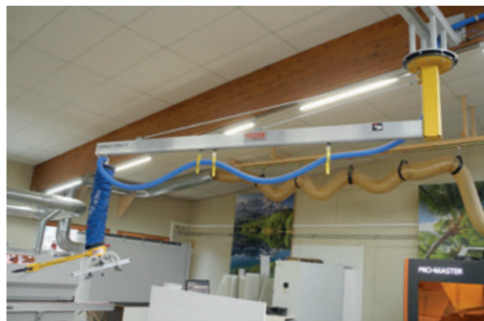
DSK-3500-100KG mit 360°-Schwenkbereich zum Bestücken einer CNC-Maschine
