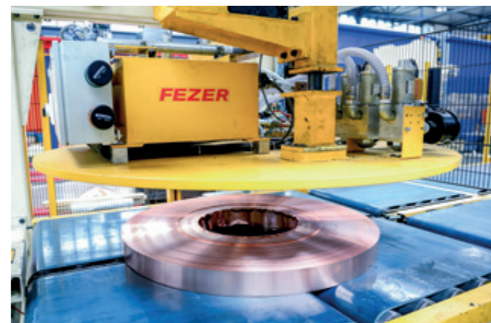
VacuCoil VCA-1000KG im Automatikbetrieb für das Umsetzen von Kupfer-Spaltbändern
