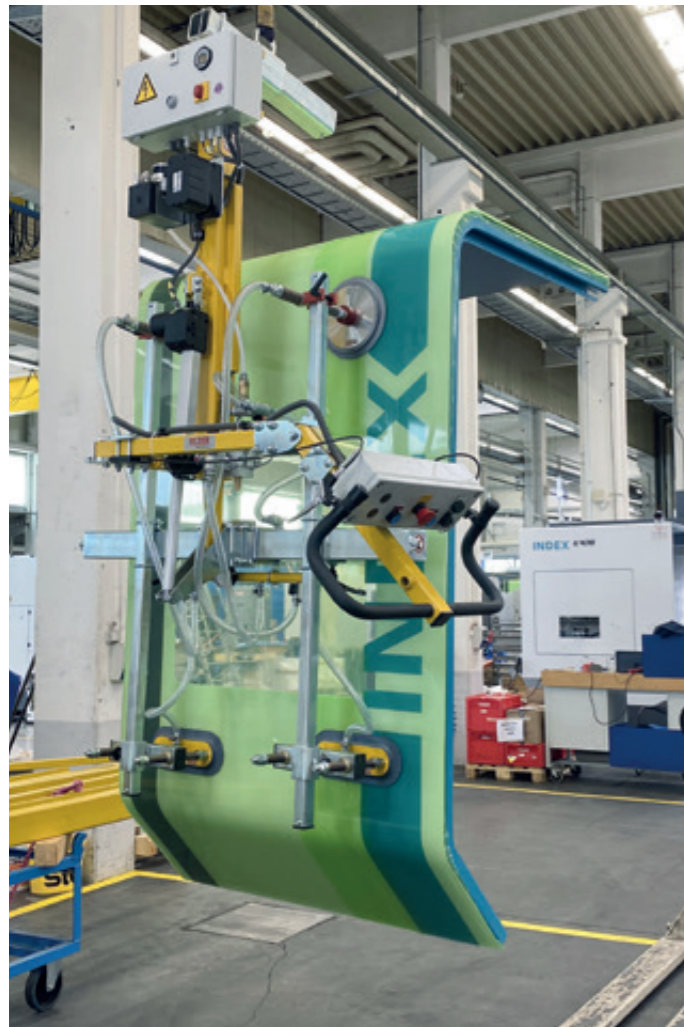
VacuBoy VB-90E-ACCU-125KG mit zweifach gelenkigen Bediengriff für die Montage von Maschinentüren an CNC-Drehmaschinen
