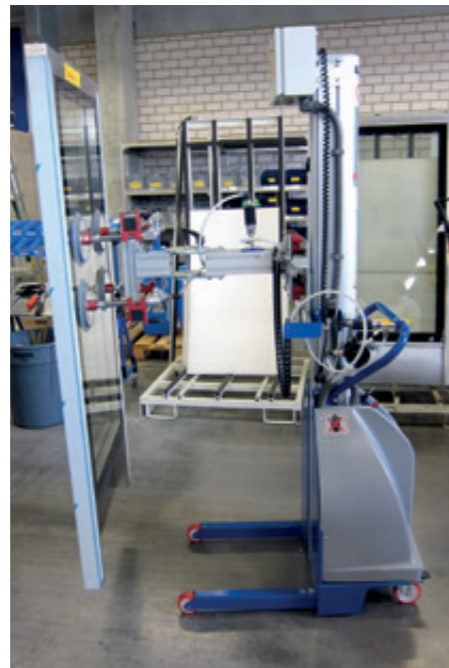
MobiliftMini ML-100KG-2000 mit manueller Dreheinheit für Fensterelemente
