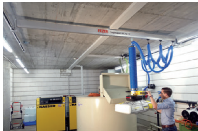
HBS-ETKA-60KG-8000x4000 Einträgerkrananlage mit Aufbockung für geringe Bauhöhe bei max. Hubausnutzung
