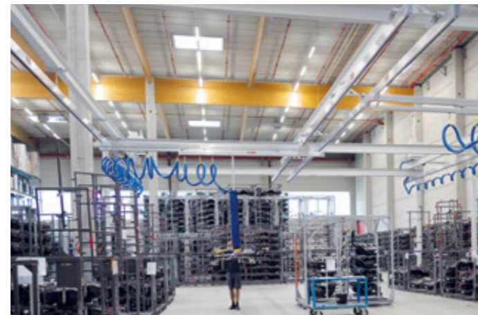
HBS-EB-80KG-12000x4000-TEL1500 teleskopierbare Einzelbrücken an einer Mehrträgerkrananlage
