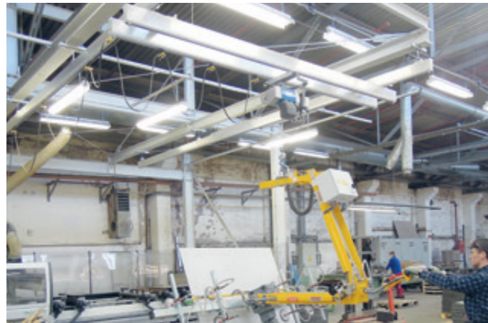
HBS-ZTK-500KG-8000x6000 Zweiträgerkran mit einer Spannweite von 6.000 mm
