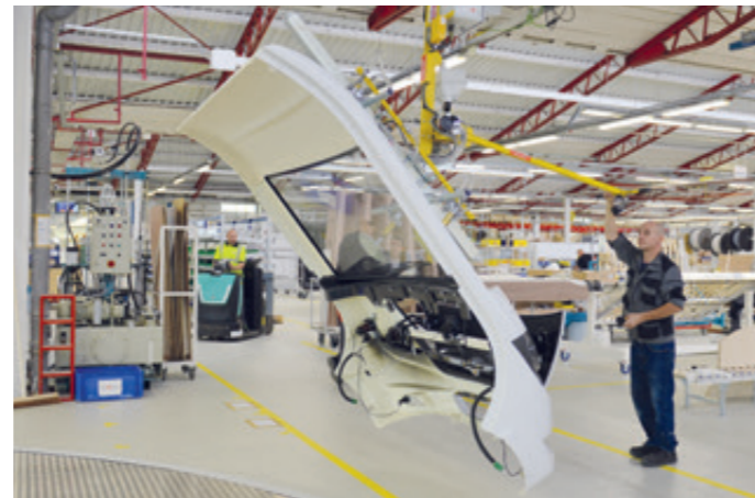
VacuBoy VB-90E-125KG beim Schwenken von Wohnmobil-Frontelementen
