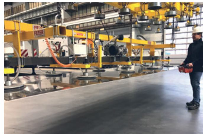
VacuBoySystem VBS-2500kg mit 4-punkt Aufhängung für Bleche bis 8.000x2.500x30 mm
