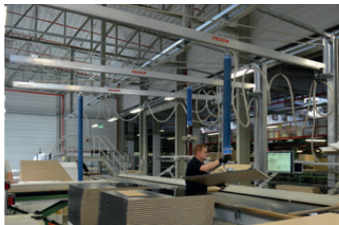
SSK-4000-60KG 3 Säulenschwenkkrane für die Kommissionierung von Holzplatten
