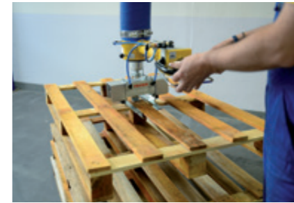
Palettengreifer Mit mechanischen Untergreifern für die Handhabung von Paletten.
