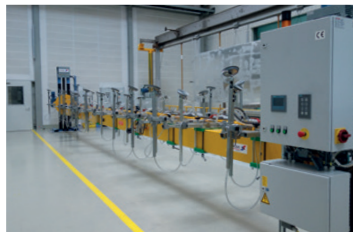
Wendestation SWS-180E-HV-250KG mit Höhenverstellung für das Wenden von Aluminiumblechen bis 13.000 mm Länge
