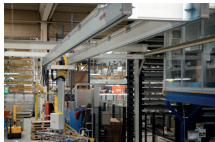
HBS-ZTK-500KG-TEL-8000x6000 Zweiträgerkran mit starrem Hubsystem Liffix
