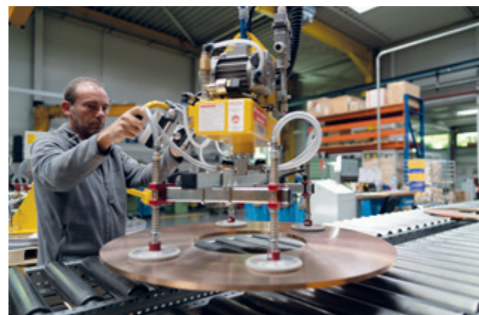
VacuBoyMini VBM-125KG Handhabung von Kupfer-Spaltbändern mittels 4-fach Aufsatz
