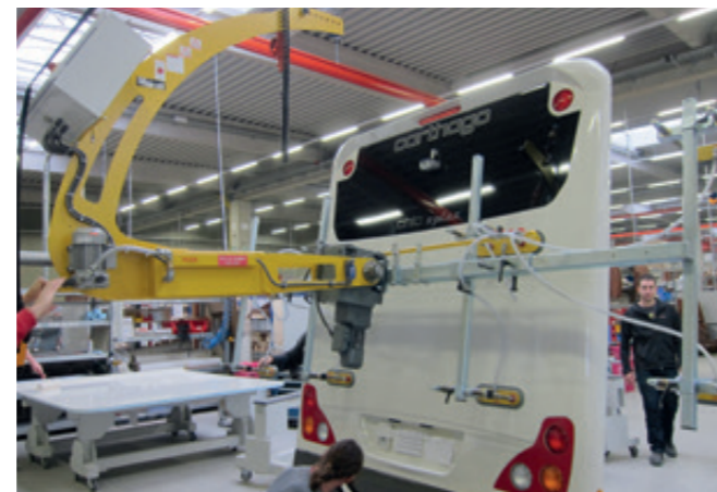
VacuBoy VB-180E-250KG zum Wenden und als Montagehilfe von Heckelementen für Wohnmobile
