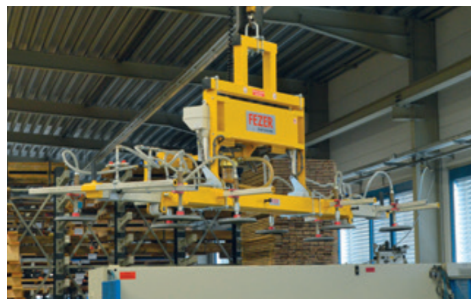
VacuBoySystem VBS-90E-750kg-TEL für Sandwichelemente mit Längen von 6.000-10.000 mm
