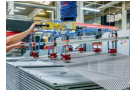
Magnetgreifer Mit pneumatischer Ansteuerung für die Handhabung von Lochblechen.
