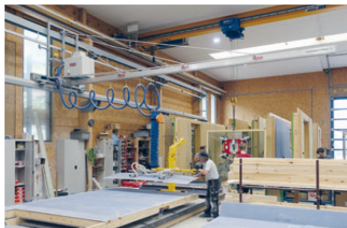
Wandlaufkran WLK-80KG-36.000x7.500 für Fermacell, MDF- und Spanplattens bis 3.000x1.250 mm
