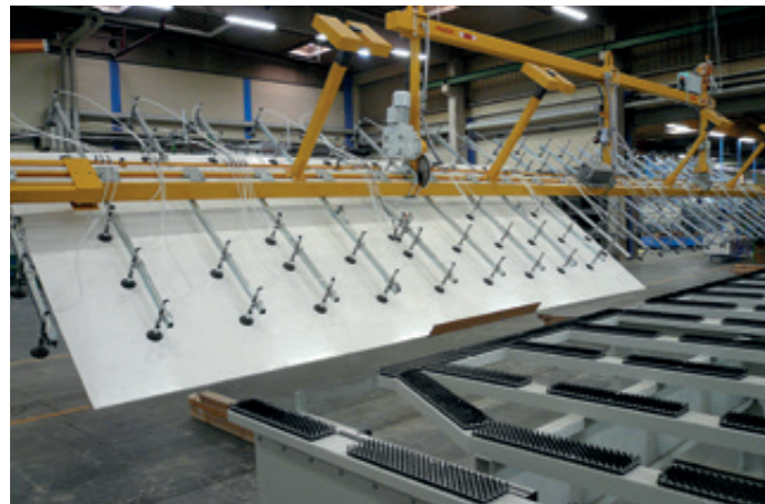
VacuGiant VG-90E-2500KG für LKW-Seitenteile bis 13.500 mm Länge
