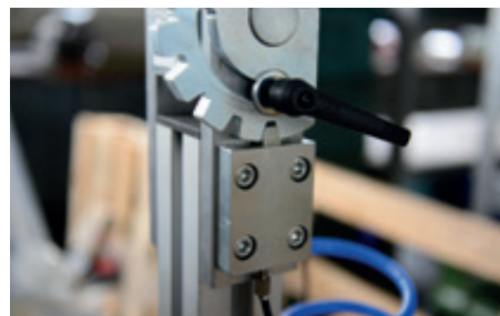
Rastmodul RM-4 mit Rastmodul für 4 Stellungen, alle 22,5°. Bedienung über Fußpedale
