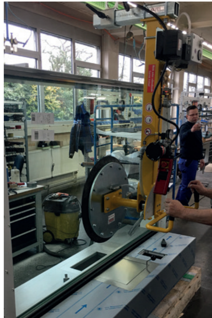
VacuBoy VB-VERT-180-125KG Handhabung von Fensterelementen im Fertigungsprozess
